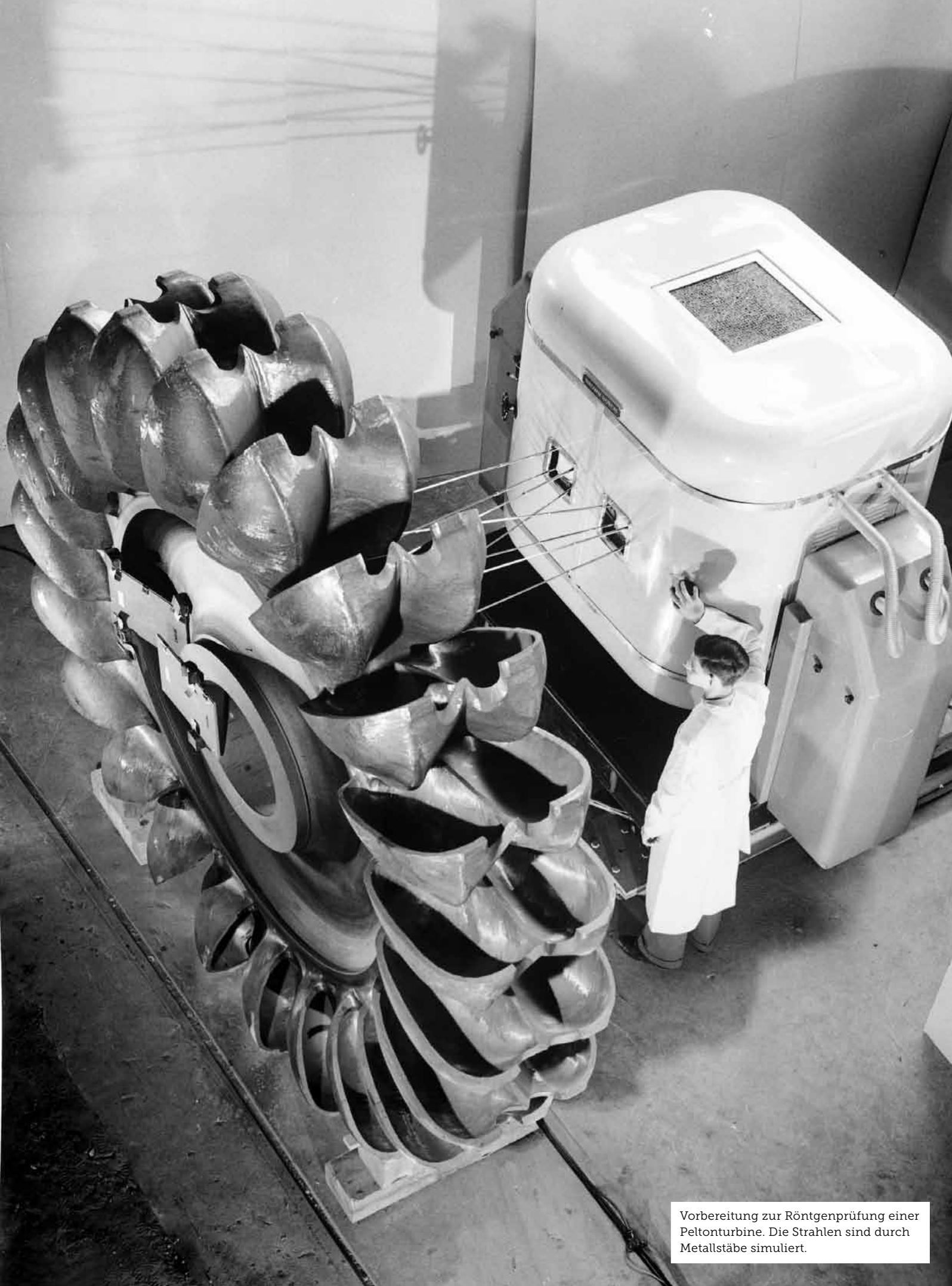
Vorbereitung zur Röntgenprüfung einer Pelton-turbine. Die Strahlen sind durch Metallstäbe simuliert.
